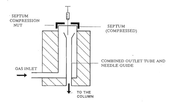
FIGURE 4.5. THE INJECTION SYSTEM
